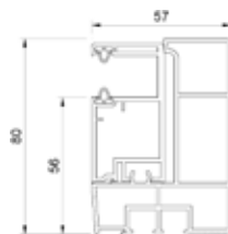
Coulisse (PVC) unilatérale - Trappe de révision RS de l'extérieur. MK933 + MK9760
