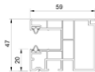
Coulisse (PVC) unilatérale - Trappe de révision RS de l'intérieur. MKM928(7)
