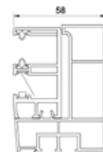
Coulisse (PVC) unilatérale + MKT* - Trappe de révision RS de l'extérieur. MK8120 + MK9760
